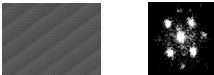
圖六：四個光點所計算出的電腦全像片 圖七：經物鏡所看到的雷射亮點
