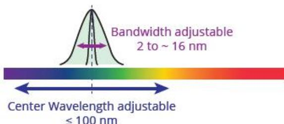
FWS Mono 是一款基于专利的 TwinFilm™技术的可调波长选择器，将光栅单色仪的波长和带宽调谐与大孔径滤光片的成像优势相结合，通过 USB 接口传输控制。FWS 波长选择器是一个简单的、交钥匙的解决方案，具有消光和优秀的传输性能。在整个可见光谱范围内，适用于需要波长控制的任何成像应用，易于和摄像机、显微镜或其他仪器集成在一起。
