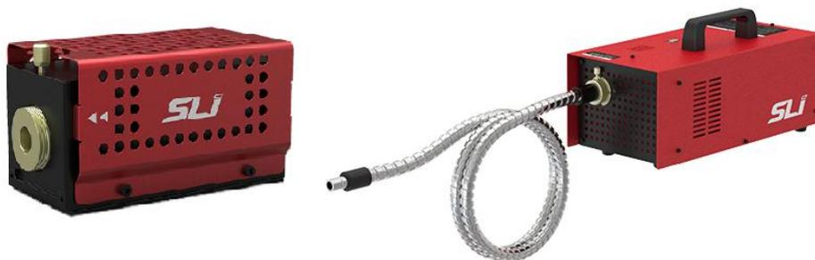
Mighty Light 是一款紧凑型的白光光源，适用于显微镜，光谱学，机器视觉和光谱成像应用。Mighty Light 将卤钨灯灯泡和电源控制板集成在一起，该控制板可提供独特的低噪声输出，输出功率可达 2W。预对准固定件将宽带光输出耦合到光纤或光纤束中，进行均化和准直，最终耦合到用户的显微镜中，或者与 FWS 波长选择器组合，以创建可调谐的单色光。
