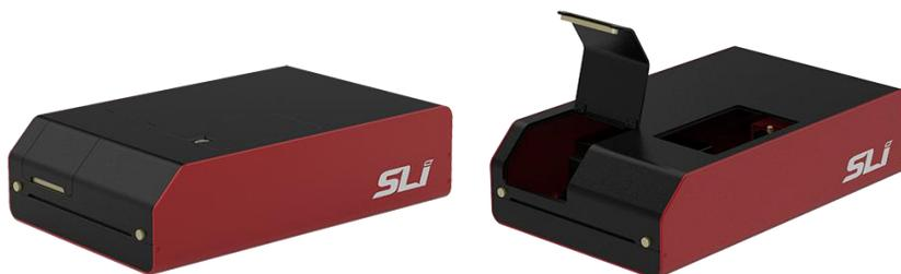
FWS 荧光计是一种采用最新技术的快速荧光计，应用广泛。FWS 荧光计中集成有 Mighty Light 卤钨灯光源和 FWS 波长选择器，以产生高功率的可调谐单色光束来激发荧光。探测部分则使用高信噪比的 CCD 进行快速、灵敏的激发荧光检测。
