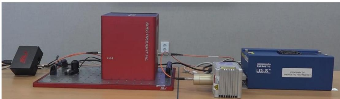
FWS Auto Poly 波长选择器搭配美国 Energetiq 公司的激光驱动白光光源(Laser-Driven Light Source, LDLS™), 可以构成完美的可调谐单色光源。以下使用的是 FWS-Poly-VIS Plus 型号的波长选择器搭配 EQ-99X 型号的 LDLS, 黑色的光谱仪为 SLI 公司的 SP245 紧凑型光谱仪。可表现中心波长 440-850nm 范围内的单色光, 带宽 5-15nm, 输出表现如下。
